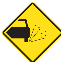
PROYECCIÓN DE GRAVILLA PE - 3
