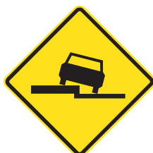
DESNIVEL SEVERO PE - 9
