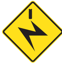
PROXIMIDAD DE CABLES DE ALTA TENSIÓN PE - 4
