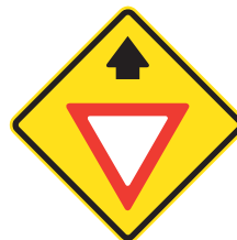
PROXIMIDAD DE SEÑAL "CEDA EL PASO" PO - 12
