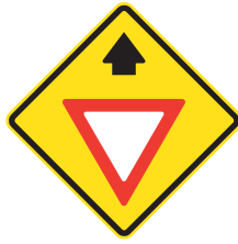
PROXIMIDAD DE SEÑAL "CEDA EL PASO" PO - 12
