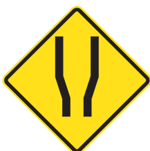
ENSANCHAMIENTO A AMBOS LADOS PF - 3a
