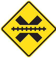
CRUCE FERROVIARIO A NIVEL SIN BARRERAS PI - 1a
