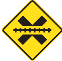
CRUCE FERROVIARIO A NIVEL SIN BARRERAS PI - 1a
