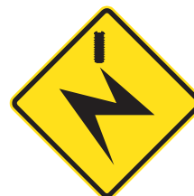
PROXIMIDAD DE CABLES DE ALTA TENSIÓN PE - 4
