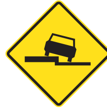
DESNIVEL SEVERO PE - 9
