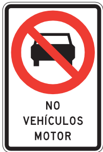
NO VEHÍCULOS MOTOR PROHIBIDA CIRCULACIÓN DE VEHÍCULOS MOTORIZADOS RPO - 6
