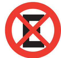
PROHIBIDO ESTACIONAR Y DETENERSE RPO - 15
